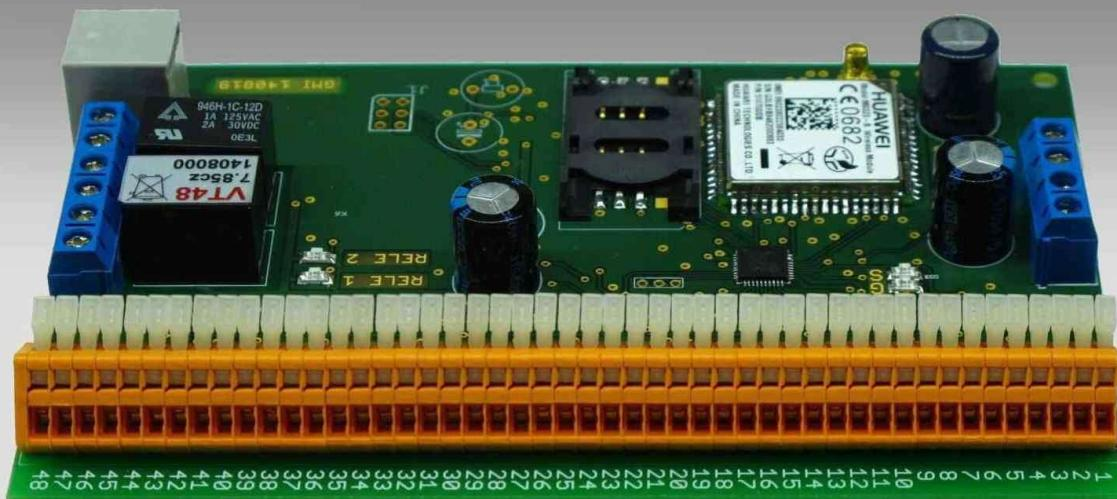
Modul s převodníkem RS232 - ETHERNET
